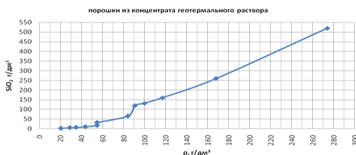
Рис. 9. Зависимость насыпной плотности нанопорошка от содержания SiO_2
