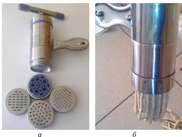
Рис. 1. Шнековый пресс для формирования макарон с матрицами (а) и процесс прессования (б)
