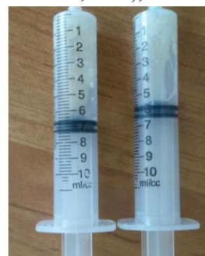
Рис. 2. Увеличение высоты подъёма поршня в результате выделения диоксида углерода
